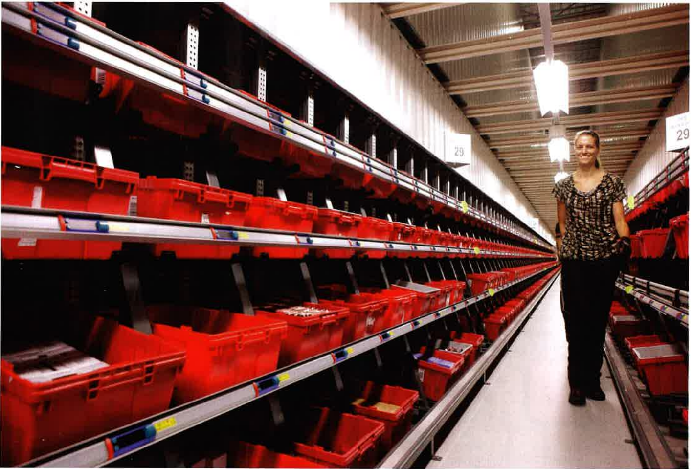
Het dc van Kruidvat in Heteren werkt met het DPS-systeem van Witron. Het systeem combineert goods-to-man en man-to-goods systemen
