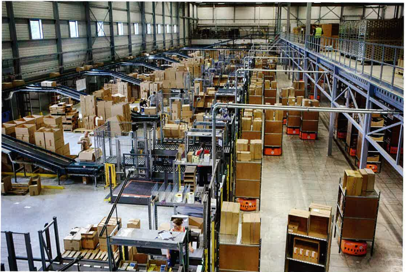
Timberland maakt in het EDC in Almelo gebruik van het Kiva systeem. 130 AGV-achtige robots brengen stellingen met dozen naar een orderpickstation
